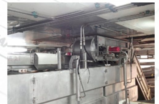
S-SHAPE CONVEYOR S-образный конвейер (гусиная шея)
