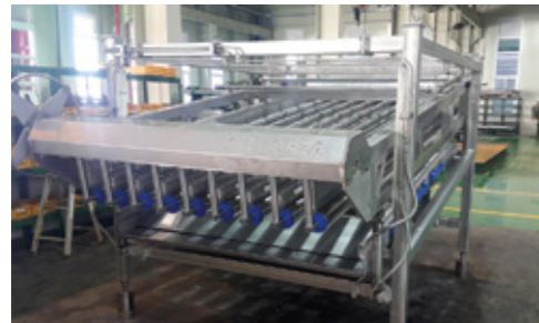
9 ROLLERS . HYD./CHAIN TYPE Тип : 9-роликовый, гидравл,цепной
