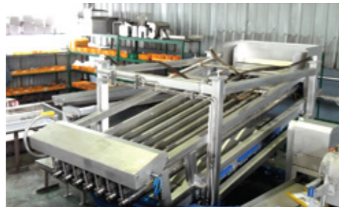
7 ROLLERS . HYD./CHAIN TYPE Тип : 7-роликовый, гидравл,цепной
