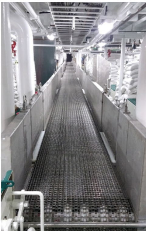
HYD. TYPE CONVEYOR Конвейер(гидравл.типа)
