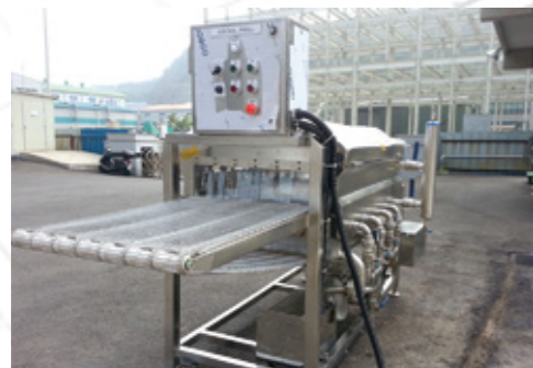
WASHING CONVEYOR SYSTEM Рыбомоечная машина конвейерного типа
