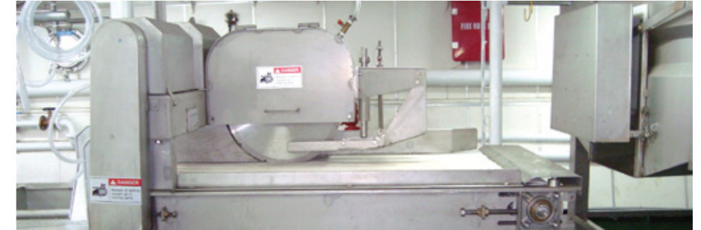
HEAD CUTTING CONVEYOR Транспортер с головоотрезающей машиной
