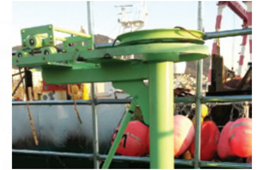
POT LIFTER Устройство для подачи ловушек
